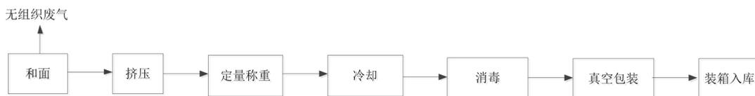
图 3-6 冷面工艺流程及产污节点图
